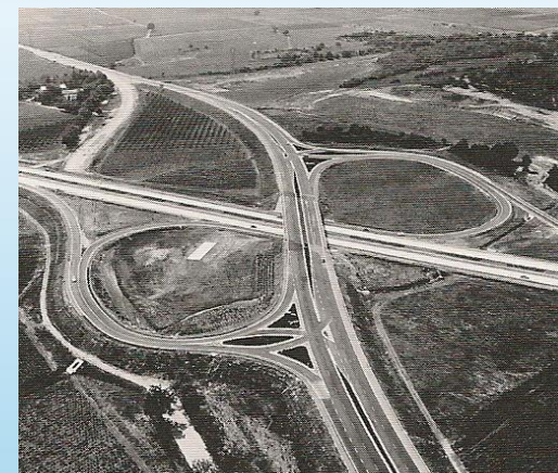
Křižovatka styková (vlevo) a průsečná (vpravo) (zdroj: Neufert, třetí vydání; 2000)
