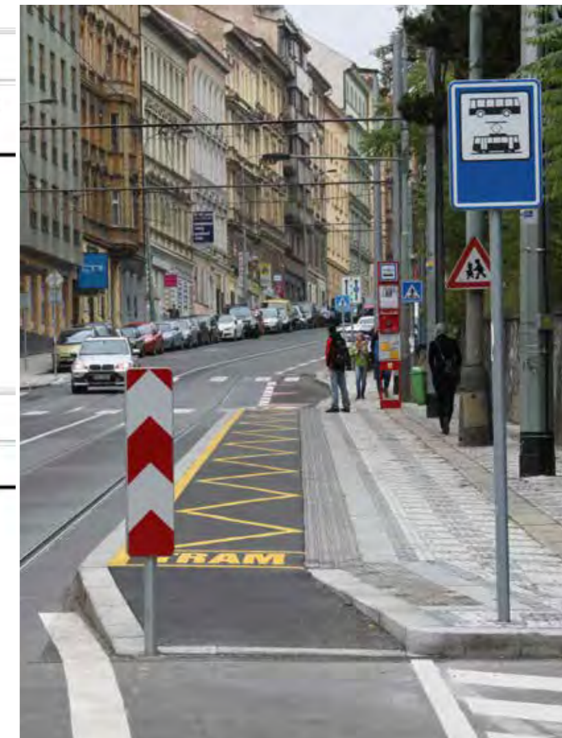
Obrázek 51 – Zastávka se zvýšeným cyklistickým pásem v rámci vyhrazeného jízdního pruhu pro cyklisty
