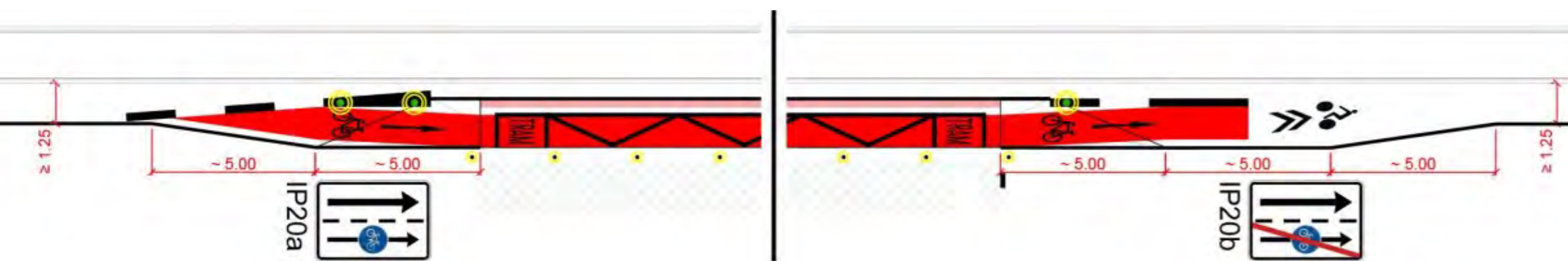
Obrázek 52 – Zastávka se zvýšeným cyklistickým pásem bez navazujících vyhrazených jízdních pruhů
