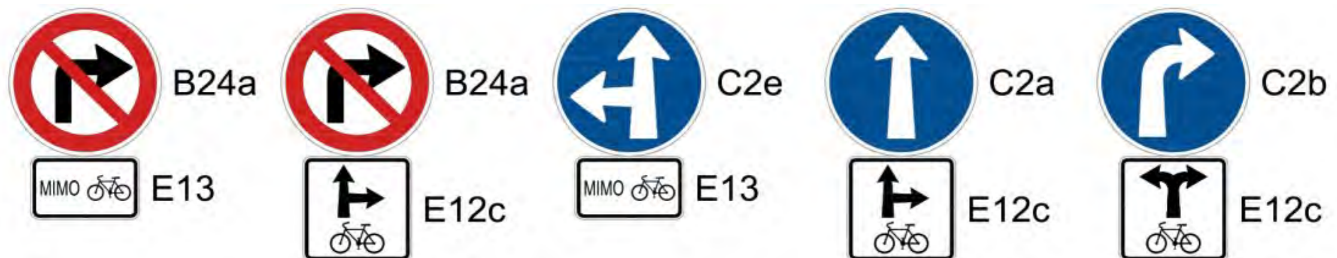
Obrázek 59 – Značení před křižovatkami s povoleným směrem jízdy cyklistů navíc oproti ostatním vozidlům
